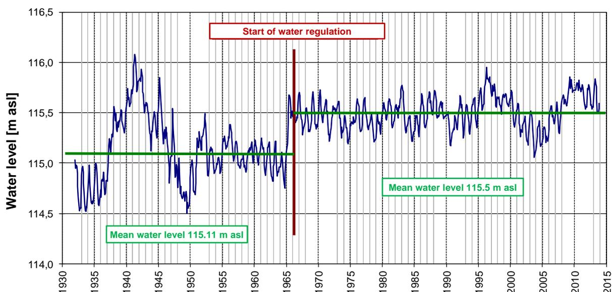
**Figure 14. Hydrograph of the lake water levels 1932–2013. Source: Amt der Bgld. Landesregierung, Referat Hydrographie.**
