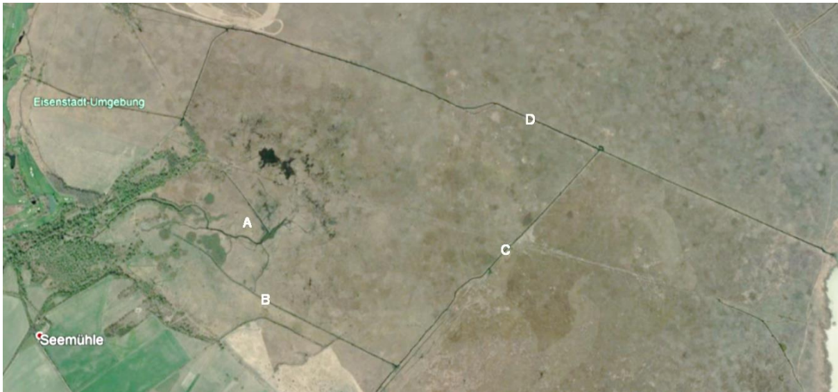
2. ábra. A Fertő tóba vezető csatornák a Vulka folyó torkolatánál. A legutóbbi csatornakotrás az A és B csatorna között történt. Alacsony kibocsátás esetén a folyó preferált útvonala a B-C csatorna, magas kibocsátáskor a folyó jelentős része keresztülfolyik a D csatornán is.
