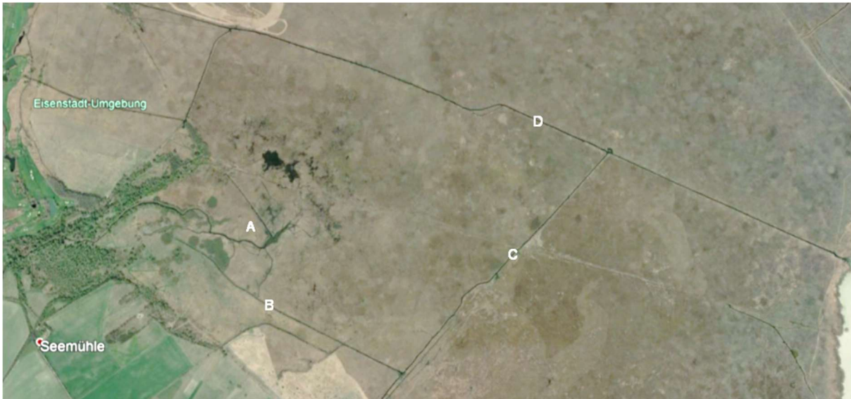
Abbildung 2. Kanäle an der Mündung der Wulka in den Neusiedler See. Die letzten Kanalbaggerungen erfolgten zwischen A und B. Kanal B – C ist der bevorzugte Weg des Flusses bei geringem Abfluss. Bei hohem Abfluss fließt ein großer Teil des Flusses auch durch Kanal D.
