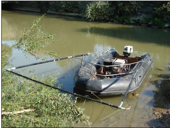
Abbildung 46: E-Befischungsboot mit Ausleger für den Anodenrechen
