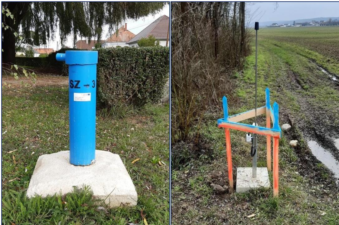
Abbildung 13: Gebohrte Grundwassersonden (links: ungarische Grundwassersonde; rechts: österreichische Grundwassersonde)
