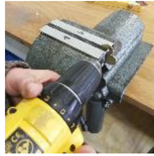
Werkstück einspannen und Loch bohren.
