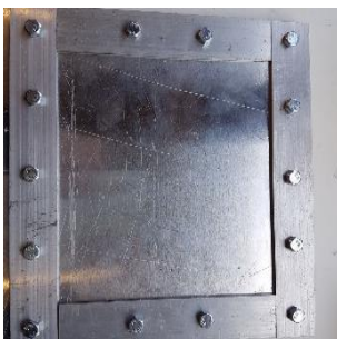
Seitenteile mit den Schrauben an der Rückplatte befestigen
