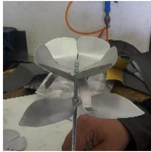
Längliche Blätter und unterstes Blütenblatt an die Gewindestange anbringen und zurechtbiegen
