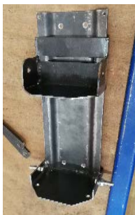
Oberen Teil der Presse mithilfe der Schiene auf Hauptkörper schieben
