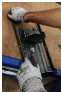
...und entsprechend festziehen. ACHTUNG: sie müssen noch beweglich sein!
