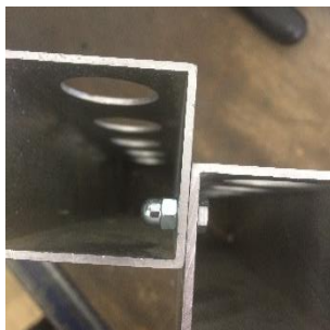
Alle 3 Teile zusammenschrauben (M4 Schrauben)
