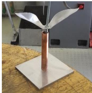
Kupferrohr in Grundplatte einpressen und Rose hineingeben
