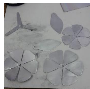
Alle Teile ausgeschnitten und entgratet
