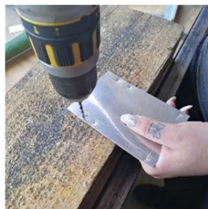
...und die Löcher für die Achsen bohren (20 mm vom oberen Rand).
