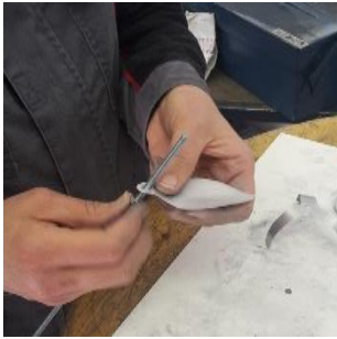
Blätter auf die Gewindestange auffädeln, zurechtbiegen und mit Muttern fixieren
