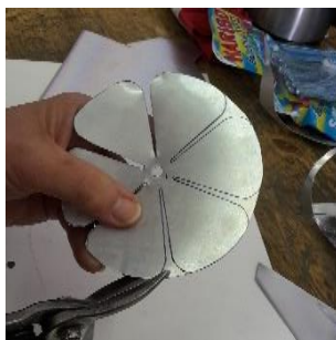
Form mit der Schere aus dem Material ausschneiden
