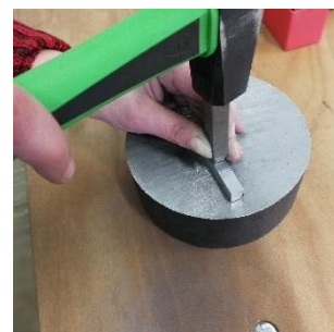
Material auf stabilen Untergrund auflegen und Buchstaben einschlagen
