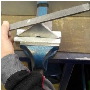
Grundplatte zentrisch/mittig mit 14,9 mm Bohrer bohren, Ecken der Grundplatte rund feilen und Kanten entgraten
