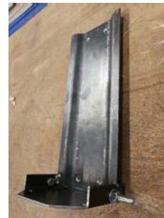
Schrauben für die Arme am zuvor geschweißten Hauptkörper anbringen
