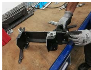
Am oberen Ende des Hauptkörpers die beiden Schrauben als Stopper anbringen...
