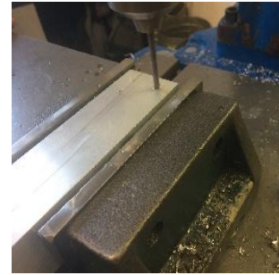
Löcher bohren (4er) Loch für Ständer (6er)
