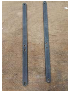
Selbe Vorgehensweise mit den beiden langen Armen. Alle Arme an den Enden abrunden.
