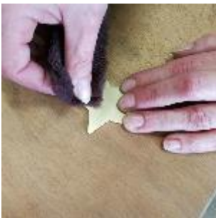
Oberfläche mit Schleifvlies bearbeiten
