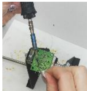
und die Anschlussdrähte mit der Leiterplatte verlöten.
