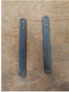
Kurze Hebelarme anreißen und entsprechend Bohren
