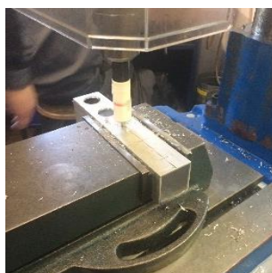
Löcher bohren (Dosenbohrer)...
