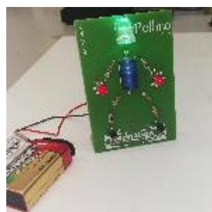
Funktionsüberprüfung mit 9 V Blockbatterie
