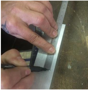
Kleine Löcher (für die Verbindung) kennzeichnen...
