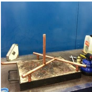
Enden mit Lötpaste bestreichen und Teile für den Boden zusammenstecken
