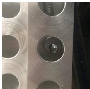
Mit M6 Schraube am Ende den Ständer anbringen...
