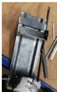
Auf der Unterseite des Hauptkörpers, beide langen Arme anbringen...
