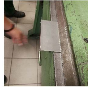
Alle drei Bleche biegen (alternativ mit Hammer)
