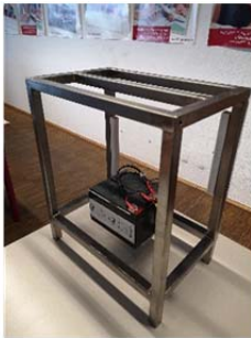
Plexiglasplatte (mit Ausschnitt) einlegen und Akkus darauf platzieren
