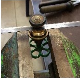
Ventil am Wasserhahn absägen (damit das Kabel nicht abgeklemmt werden kann)
