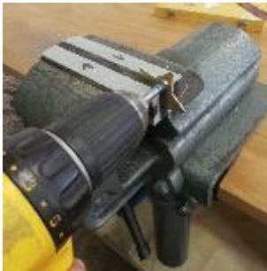
Senker in den Akkuschauber einspannen und Bohrloch senken.
