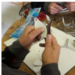
Kanten abschleifen (entgraten)
