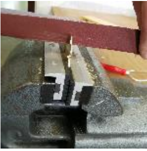
Kanten und Ecken mit dem Schleifpapier nachschleifen.
