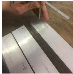
... und körnern (drittes Teil wird zusätzlich mittig markiert/gebohrt → Ständer)
