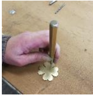
Körner gerade ansetzen und körnern. Position kann frei gewählt werden.
