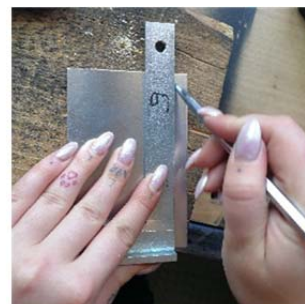
Faltkanten an großer Platte anreißen (lt. Plan)
