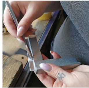
Die Falkanten der beiden Streifen ebenfalls anreißen
