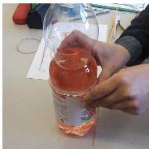
Große Biegeradien z.B. mit Hilfe einer Flasche biegen
