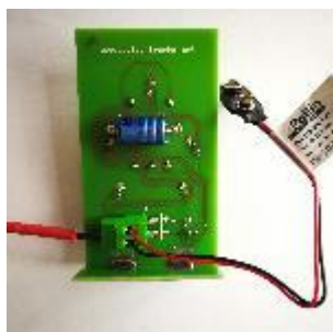
Anbringen der Anschlussklemme der Versorgungsspannung.
