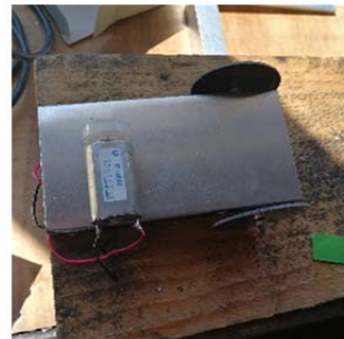
Kleines Rad auf Motor stecken und diesen ankleben
