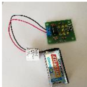
Funktionsüberprüfung mit 9 V Blockbatterie
